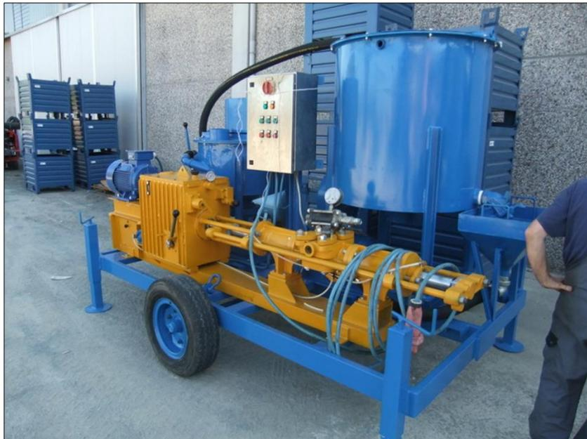
Figura 16: tipologico gruppo di miscelazione e iniezione per micropali
