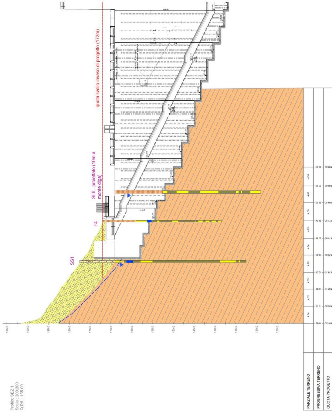
Figura 9 Sezione geologico-geotecnica 1-1
