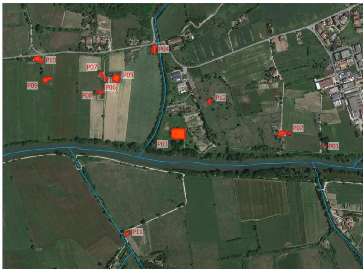
Figura 31: Punti significativi di raffronto dei battenti idrometrici per Tr=200 anni.
