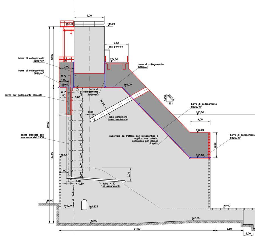
Sezione in mezzeria della pila destra
