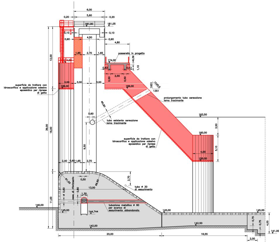
Sezione in mezzeria della pila centrale
