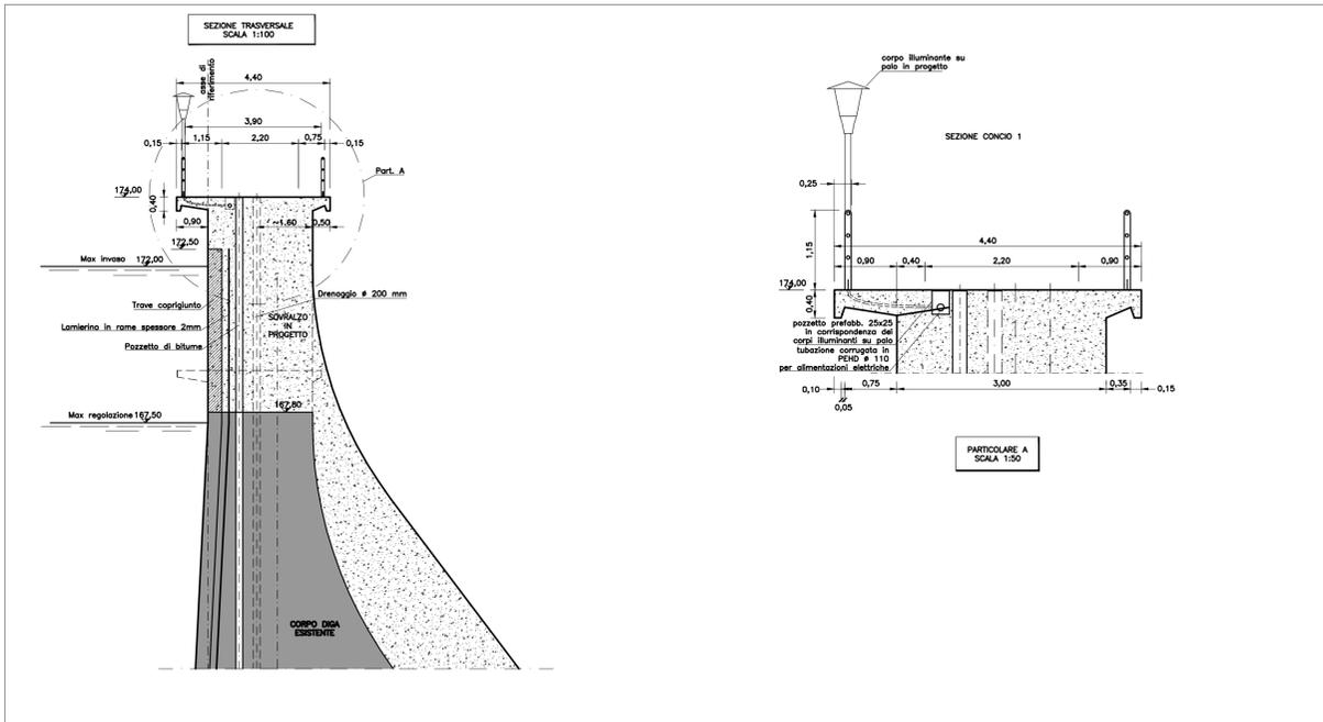
Particolari sistema di tenuta verticale e piano coronamento
