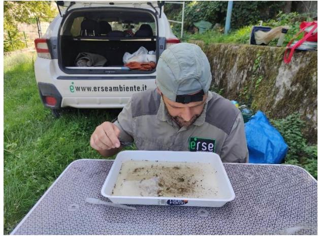
Sito Levane Valle – A sinistra: allestimento della stazione per l'analisi sul campo dei macroinvertebrati bentonici al termine dello smontaggio e del risciacquo delle lamelle dei SA. A destra: aspetto del campione durante l'analisi.
