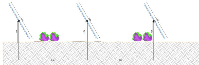
DETTAGLIO SEZIONE LONGITUDINALE STRUTTURA - SCALA 1:100
