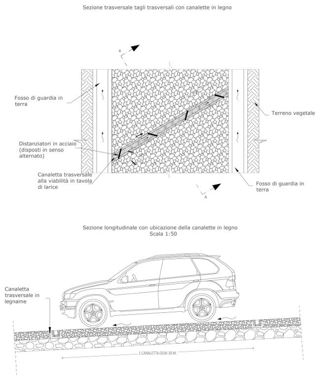
OPERA DI DISSIPAZIONE A PROTEZIONE DEL VERSANTE
