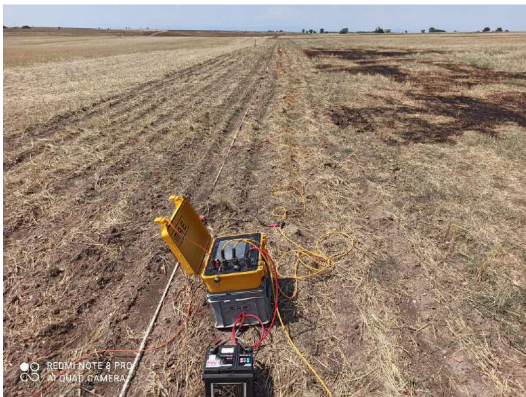
Foto 9 e Foto 10 – Vista dello stendimento sismico S5 e della strumentazione utilizzata.
