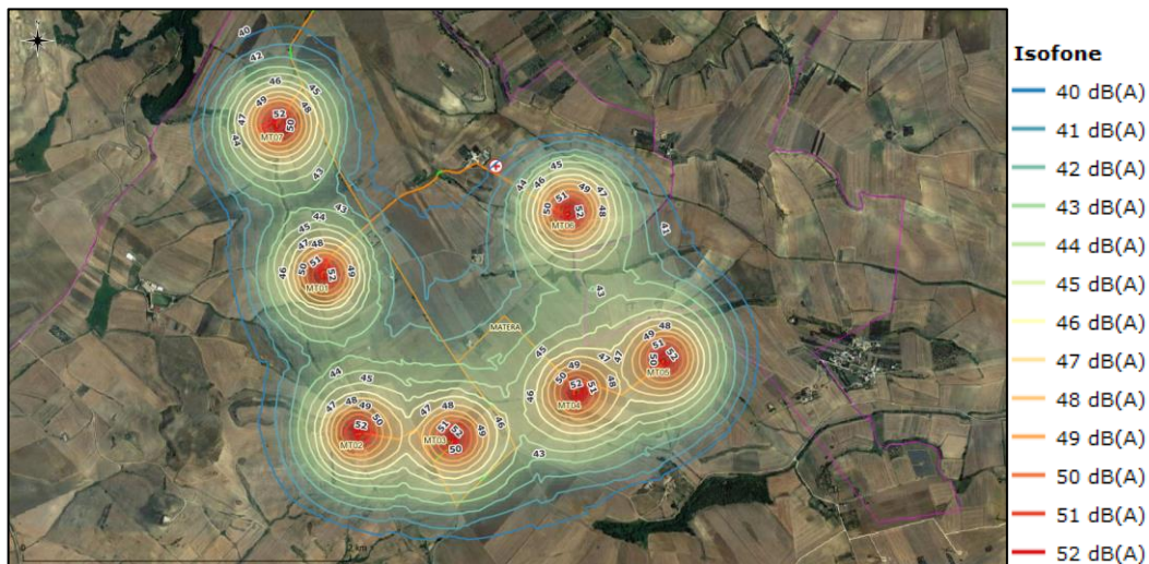
Risultati modellazione acustica – Isofona del livello di pressione sonora prodotto dall’impianto per LW 106,0 dB
