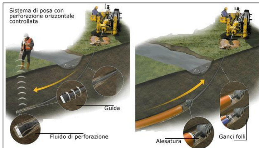
Posa in opera tubazione per alloggio cavi
