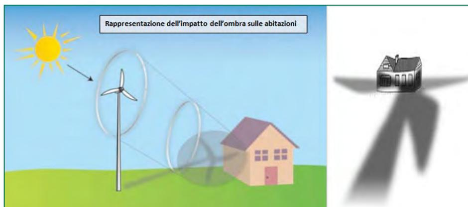
**Figura 1: Esempio grafico del potenziale effetto di ombreggiamento di un aerogeneratore nei confronti di un edificio**
