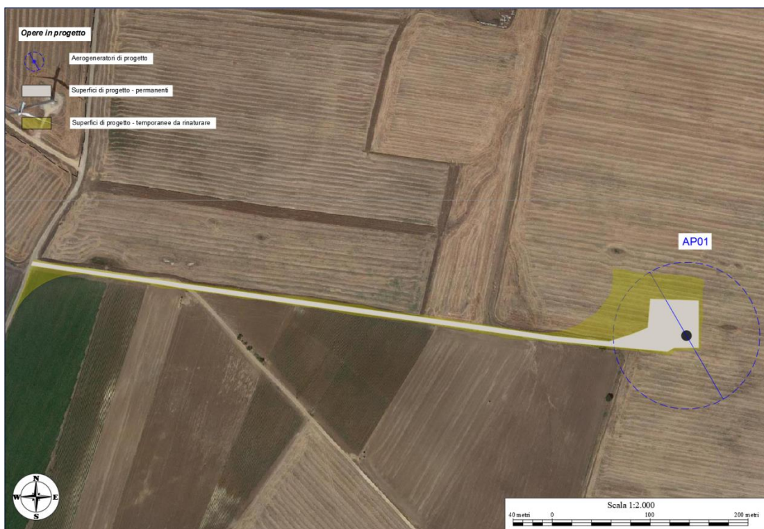
Figura 21: Piazzola a regime per l'aerogeneratore AP01
