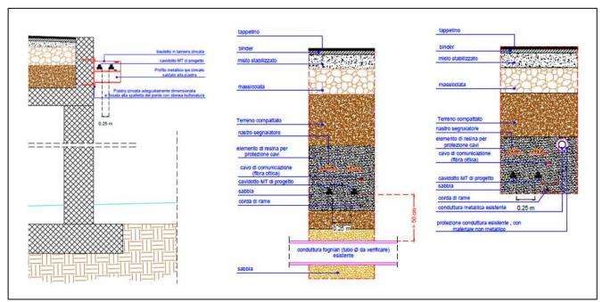
Figura 4: Risoluzione tipologica degli attraversamenti mediante staffaggio e scavo in trincea
