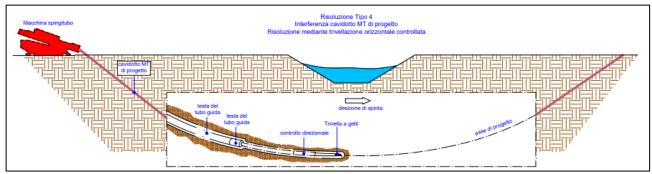
Figura 3: Schema tipologico della Trivellazione Orizzontale Controllata (T.O.C.)
