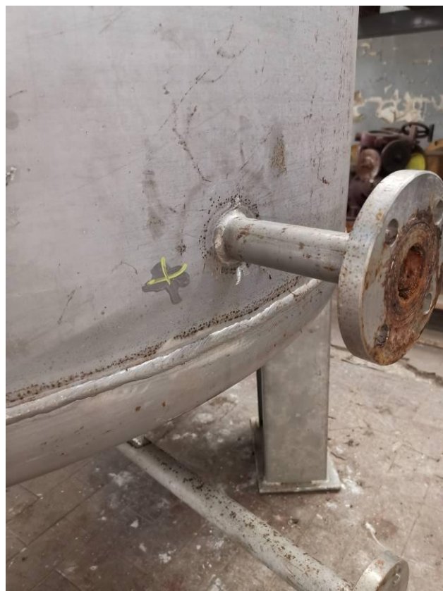
Particolare connessione al mantello
