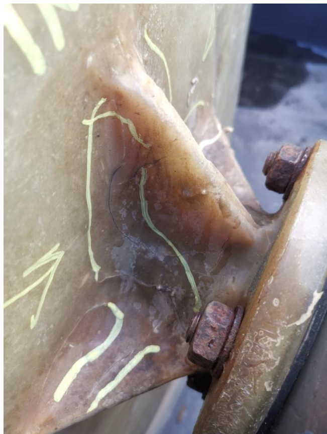
Particolare delle indicazioni sui fazzoletti di rinforzo del bocchello inferiore
