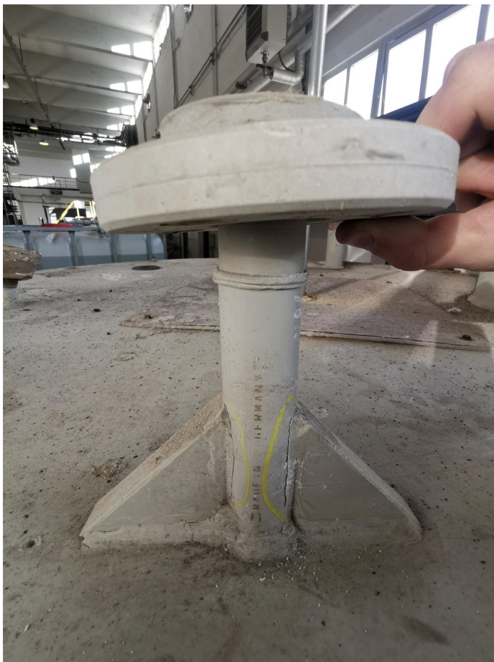
Particolare delle scollature dei fazzoletti di rinforzo sul fondo superiore
