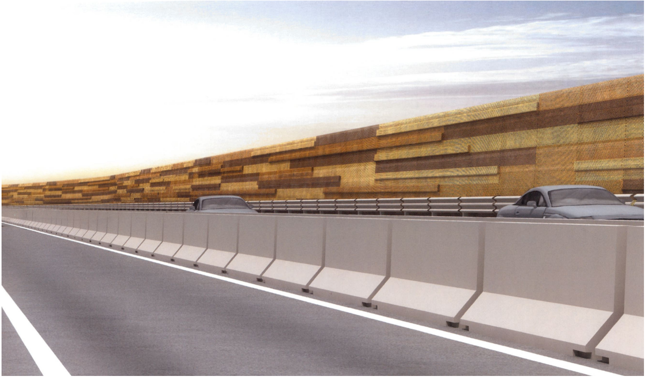
Figura 1 - Barriera in leca-cemento
