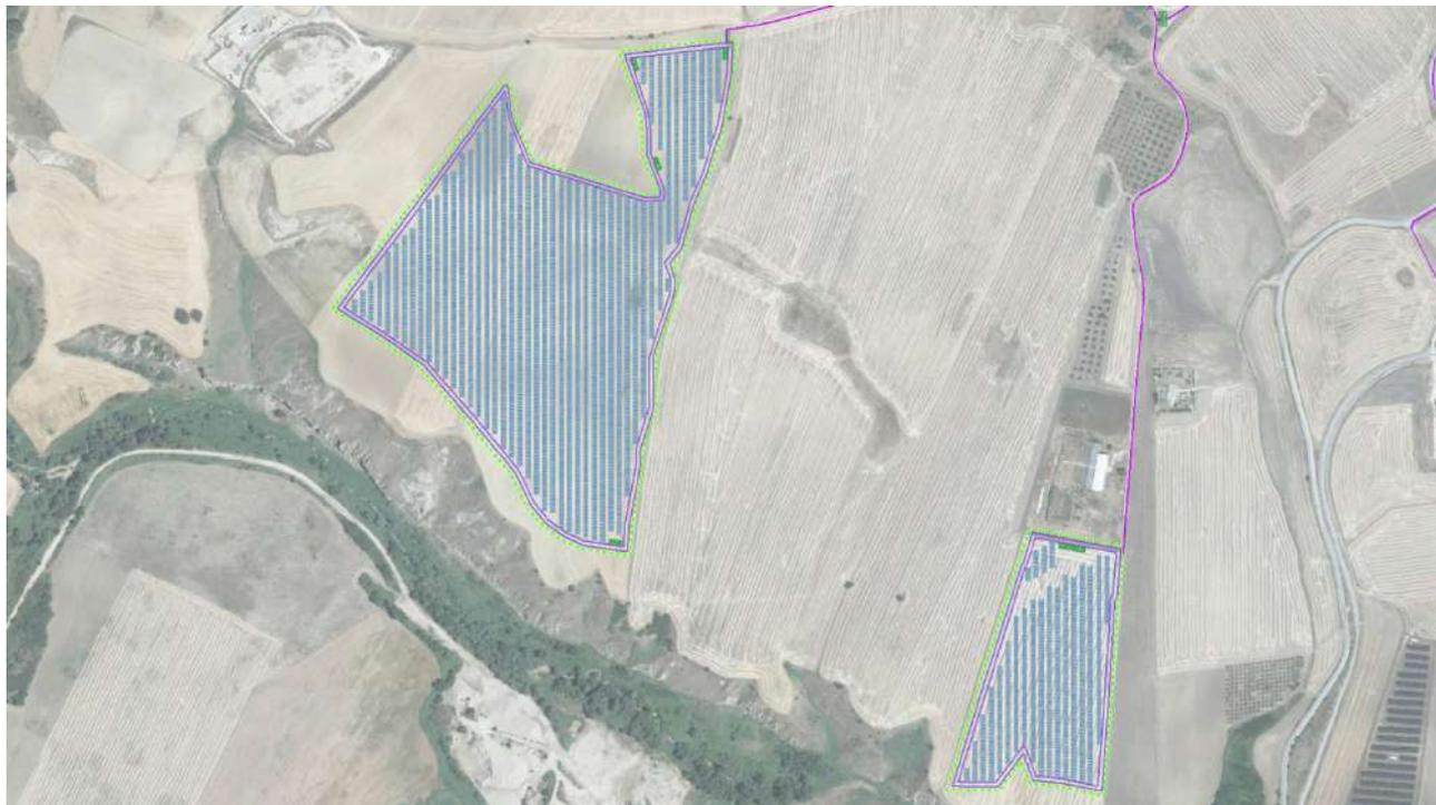
Figura 2.4.1 – Area di progetto con indicazione del posizionamento dei moduli fotovoltaici.
