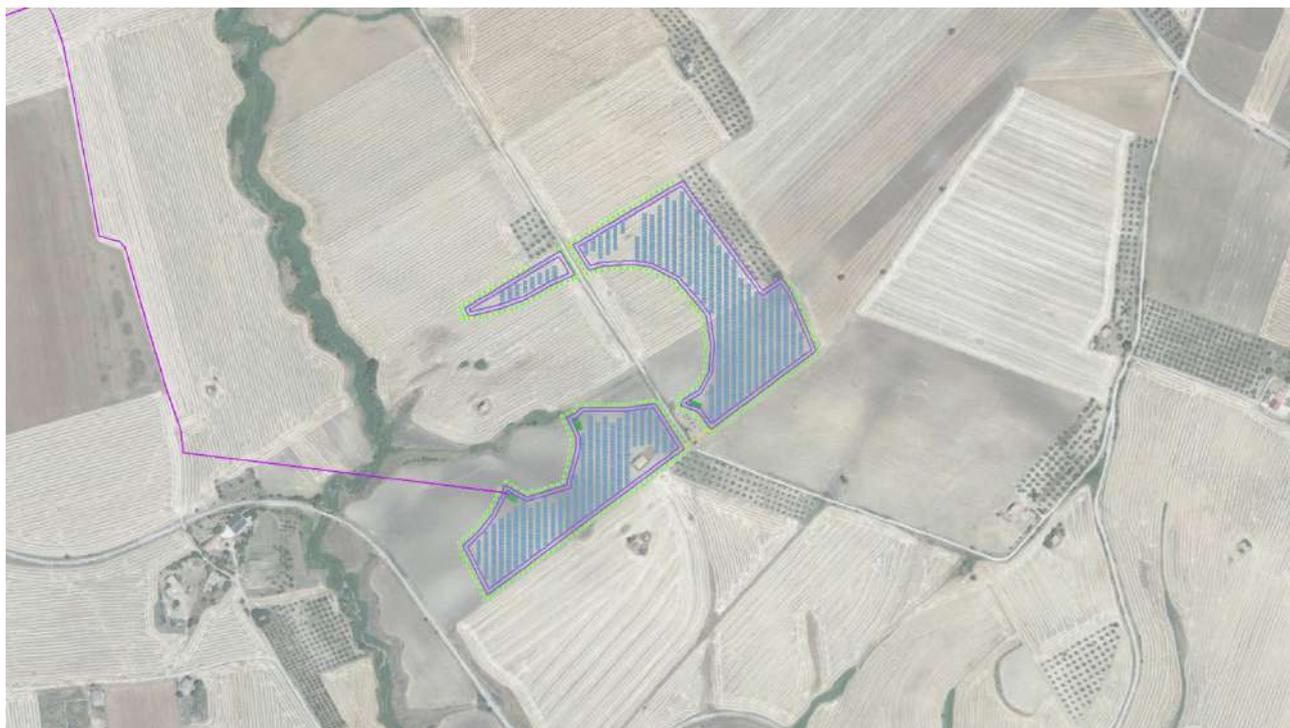
Figura 2.4.2 – Area di progetto con indicazione del posizionamento dei moduli fotovoltaici.
