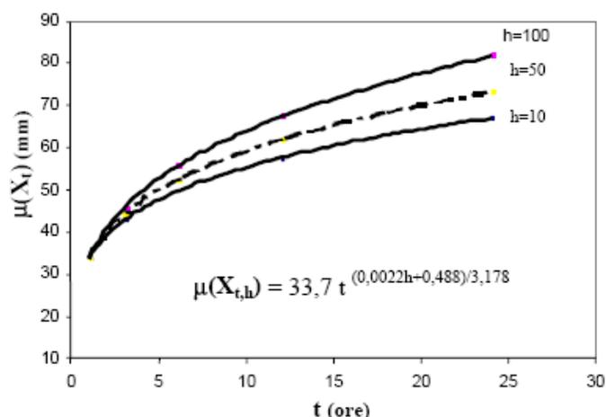
Figura 4: Curva di probabilità pluviometrica, Zona 6 (Penisola salentina).
