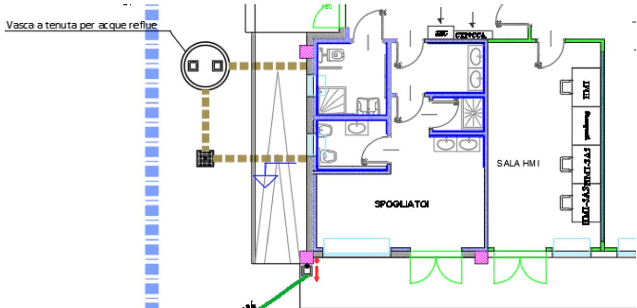
Figura 1: Planimetria della rete smaltimento acque reflue
