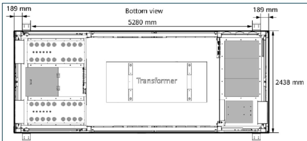
Figura 15. Caratteristiche dimensionali dell'unità di trasformazione\_Vista dal basso
