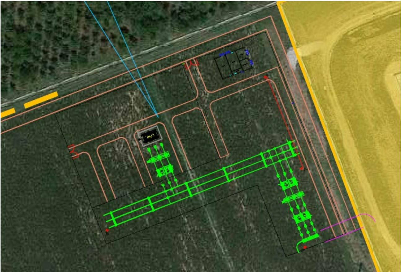
**Figura 42.** Ipotesi di distribuzione interna della stazione di trasformazione 220/30kV predisposta per ulteriore iniziativa oltre a quella oggetto della presente relazione
