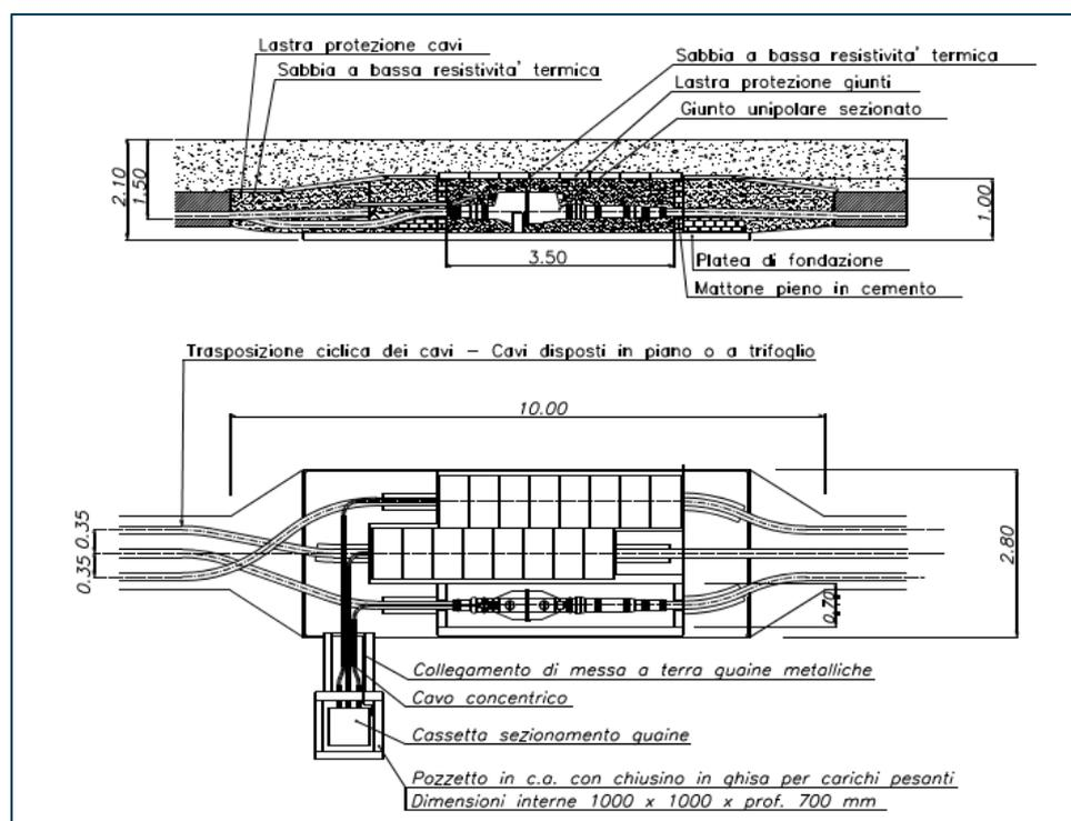
**Figura 45.** Particolare di realizzazione giunti (ove necessari)
