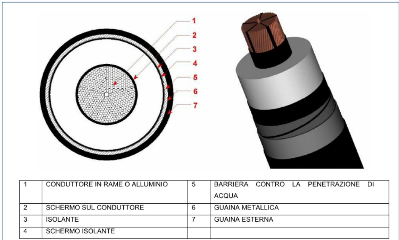
**Figura 43.** Tipologico cavo elettrico Alta tensione
