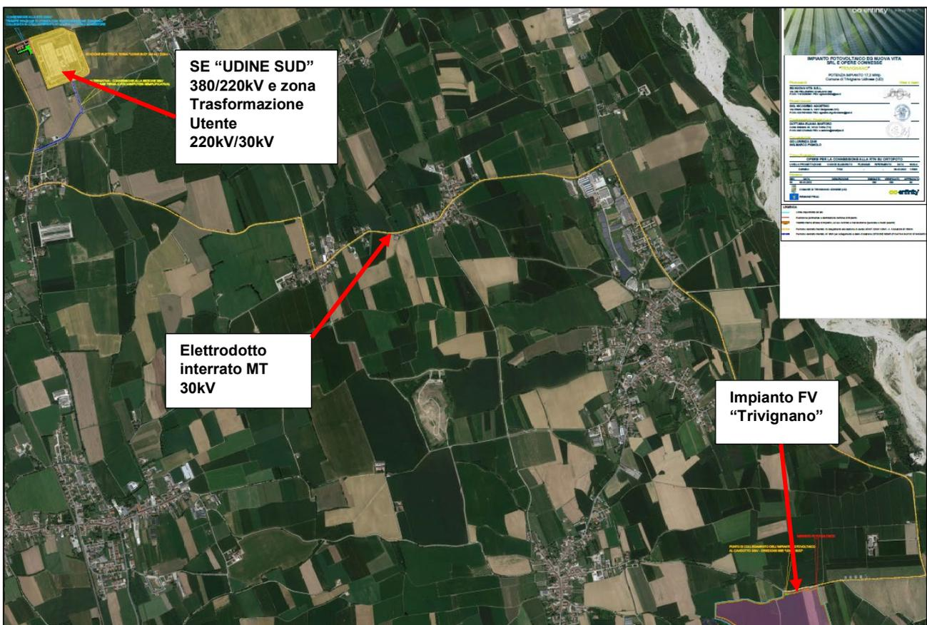
**Figura 4.** Localizzazione del punto di connessione AT 220kV alla RTN
