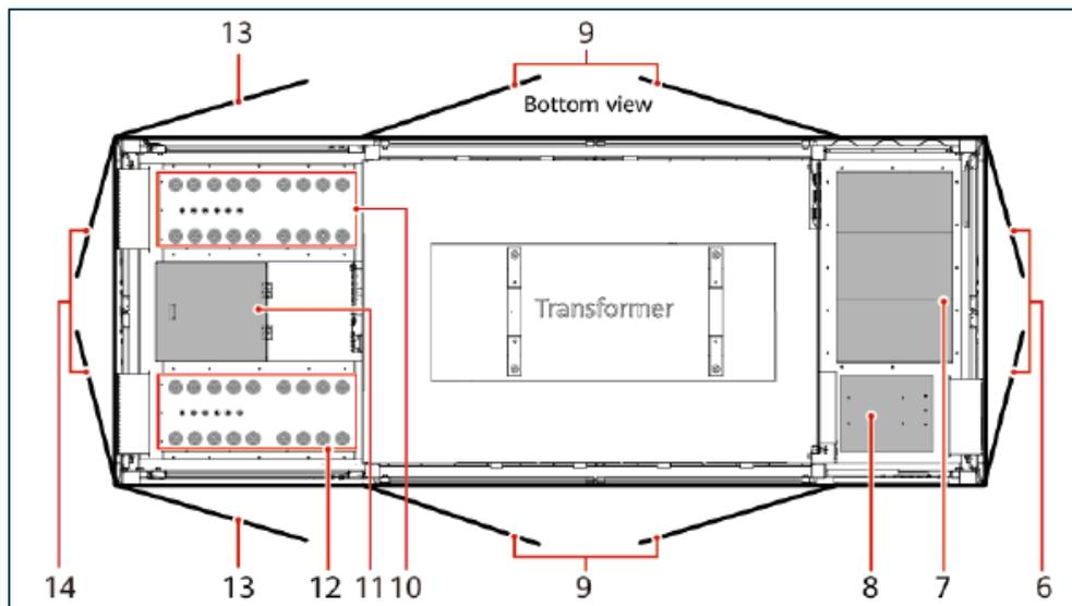
**Figura 17.** Vista dal basso\_6=Accesso locale MT; 7= Quadri MT; 8= trasformatore servizi ausiliari; 9= Accessi locale trasformatore; 10= Roxtec ingresso cavi bt; 12= Roxtec ingresso cavi bt; 13 e 14= accessi locale bt
