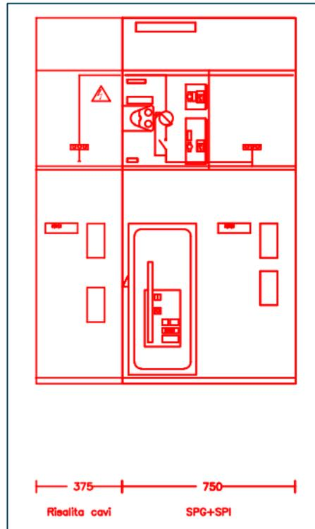
**Figura 24.** Tipologico fronte quadro scomparti MT di cabina
