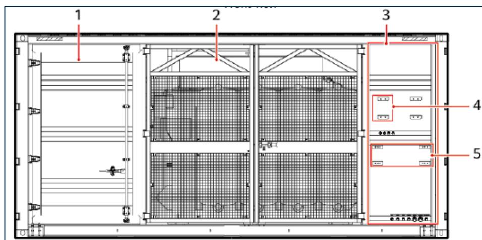
Figura 16. 1=Locale Bassa Tensione; 2= locale trasformazione; 3= locale Media Tensione; 4 e 5= componenti interni del locale Media Tensione
