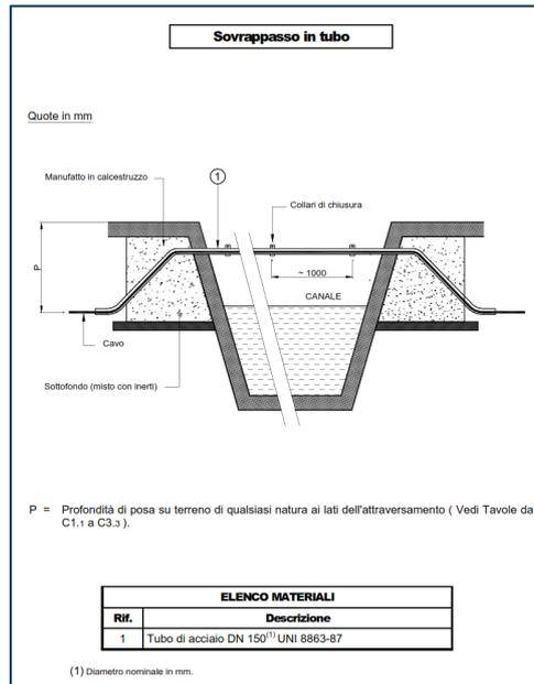
**Figura 39.** Attraversamento con sovrappasso in tubo su canale
