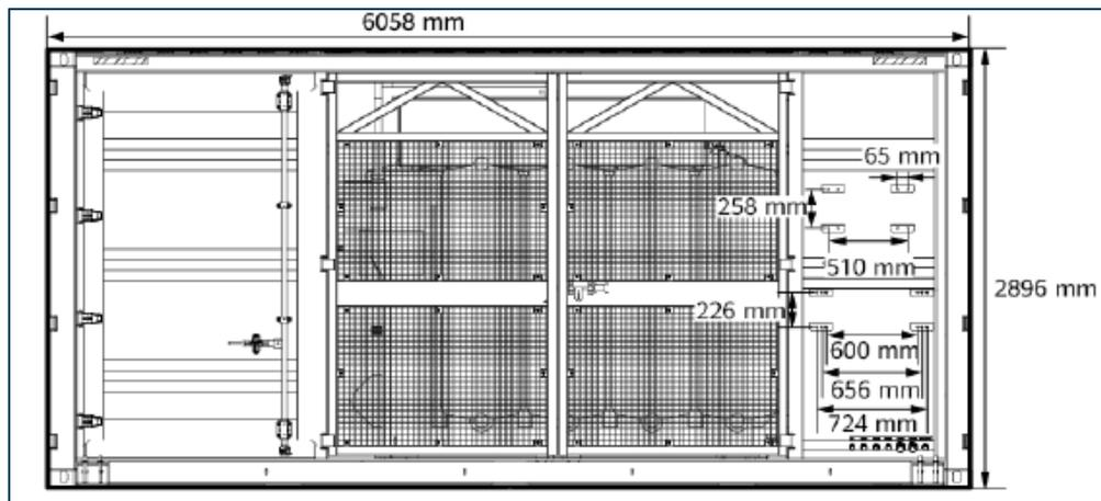
Figura 14. Caratteristiche dimensionali dell'unità di trasformazione\_Vista Frontale
