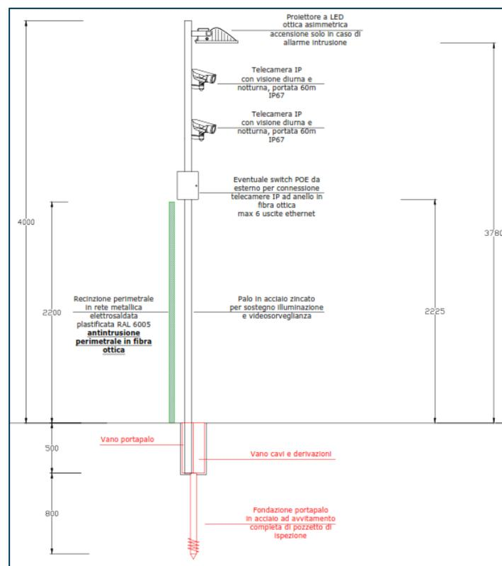
**Figura 46.** Tipologico palo per illuminazione e videosorveglianza con fondazione a vite
