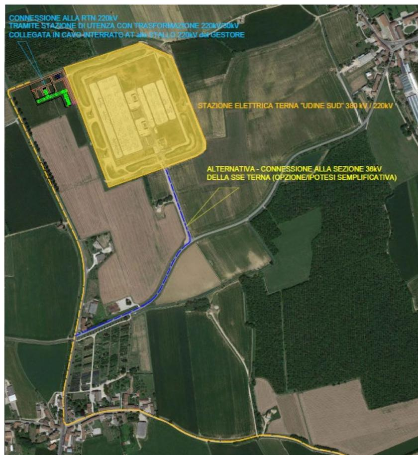
**Figura 41.** Ipotesi di posizionamento della stazione di trasformazione EG NUOVA VITA S.r.l..
