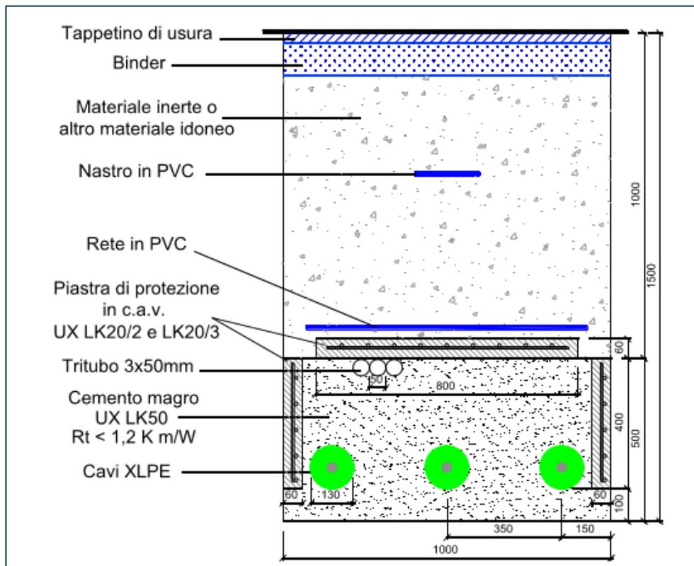
**Figura 44.** Posa su strada asfaltata di cavi 220kV e fibra ottica di comunicazione
