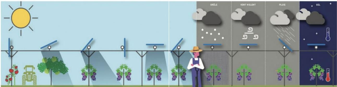
**Figura 3.** Illustrazione del funzionamento di un sistema agrivoltaico (Fraunhofer, 2020).
