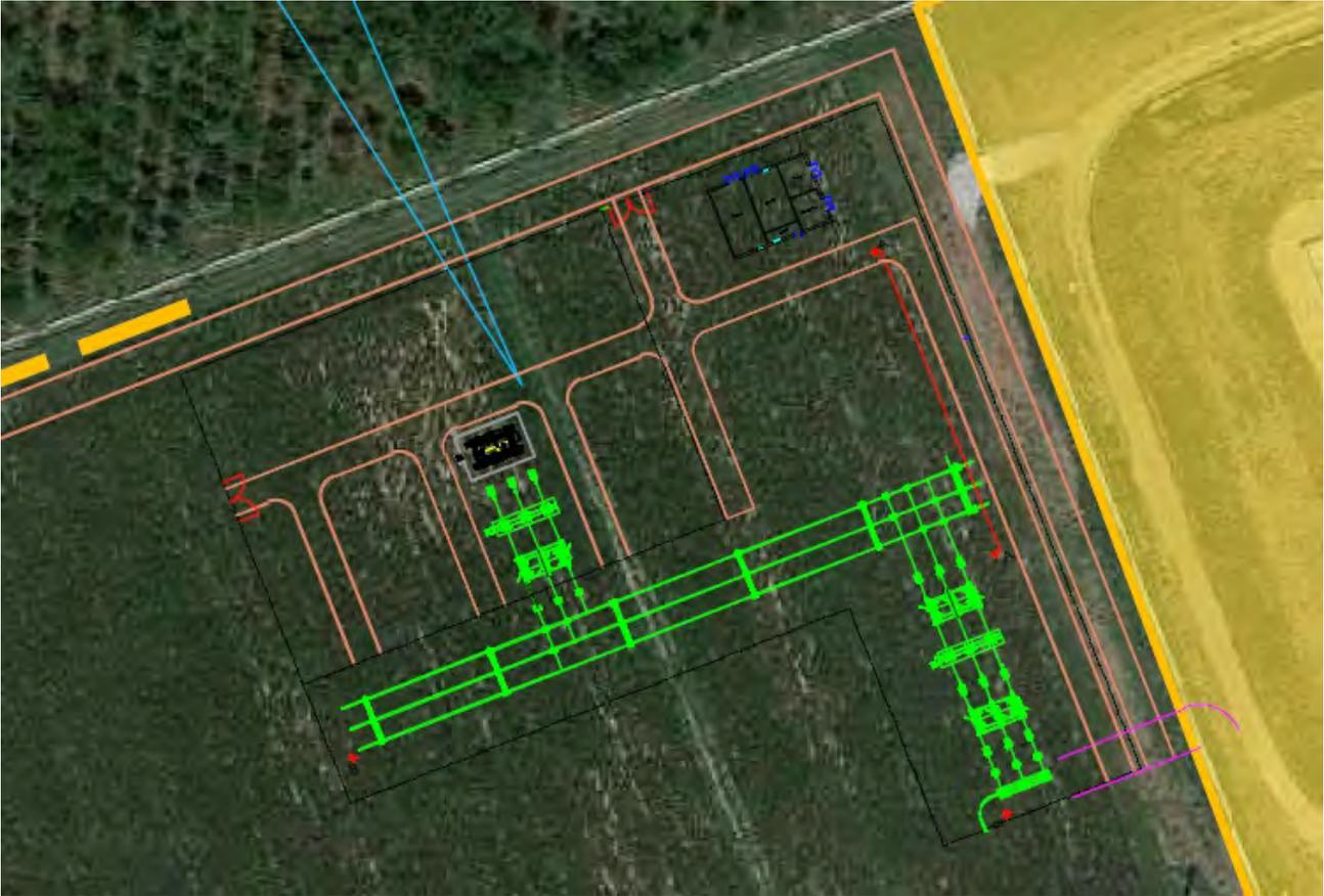
Figura 33. Ipotesi di distribuzione interna della stazione di trasformazione 220/30kV predisposta per ulteriori iniziative
