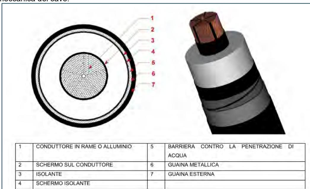
Figura 49. Tipologico cavo elettrico Alta tensione
