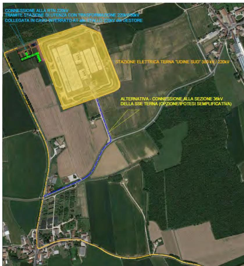
Figura 32. Ipotesi di posizionamento della stazione di trasformazione EG NUOVA VITA S.r.l..
