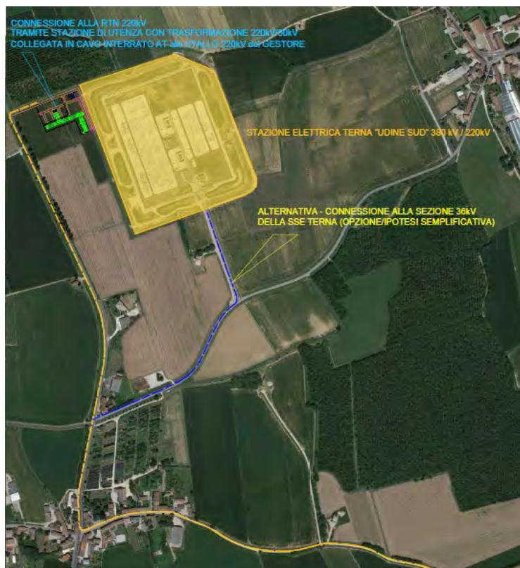
Figura 18. Localizzazione della SE "UDINE SUD" punto di connessione dell'impianto alla Rete di Trasmissione Nazionale prescelta. Linea gialla tratteggiata: tragitto del cavidotto per la connessione una stazione di utenza AT/MT 220/30 kV in prossimità della stazione elettrica Udine SUD. Linea blu tratteggiata: tragitto del cavidotto per alternativa a 36 kV.
