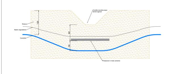
Particolare A - Attraversamento con trivellazione orizzontale controllata
