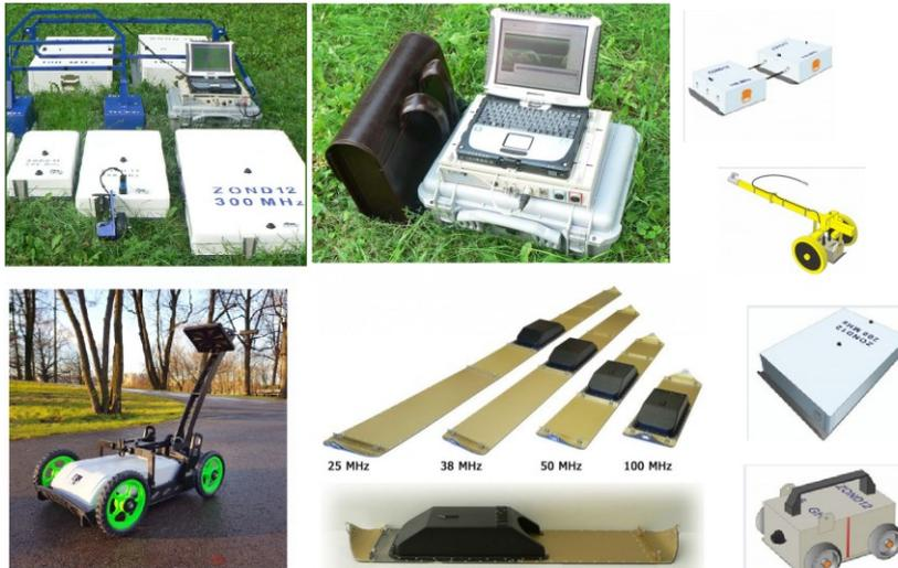
L'unità di controllo genera il segnale che viene inviato alla sezione trasmittente ed elabora il segnale ricevuto dalla sezione ricevente dell'antenna. All'unità centrale sono collegate, tramite un cavo multipolare, le antenne che hanno il compito di trasmettere i segnali elettromagnetici all'interno della struttura da indagare e di ricevere le riflessioni dovute alle interfacce elettromagnetiche presenti alle diverse profondità di indagine.
