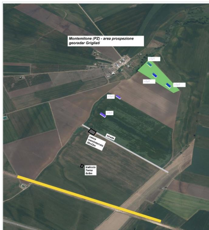
Figura14: grigliati georadar, mappa della componente in fase a 16 kHz ed elementi antropici del sito (tubi SNAM, fondazioni Terna, vasca acque, strada).
