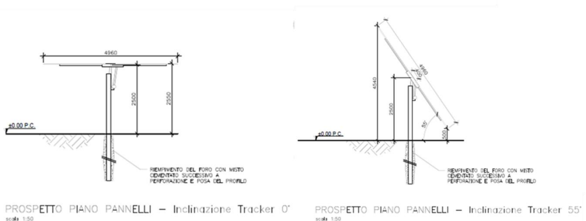
Figura 5.2 Prospetti delle Strutture di Sostegno
