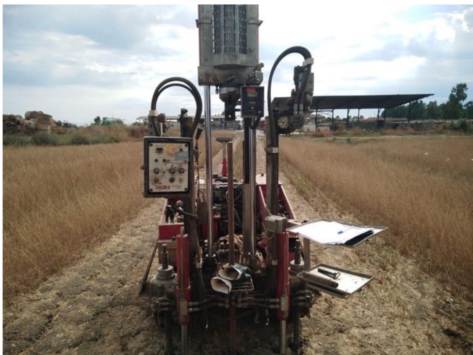
Figura 6: Prova Penetrometrica CPT eseguita
