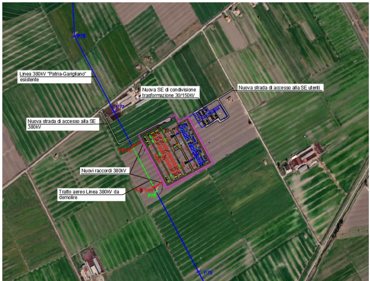
Figura 1:Ortofoto della nuova SE RTN 380/150 kV (a sinistra) e SE di condivisione/trasformazione 30/150 kV
