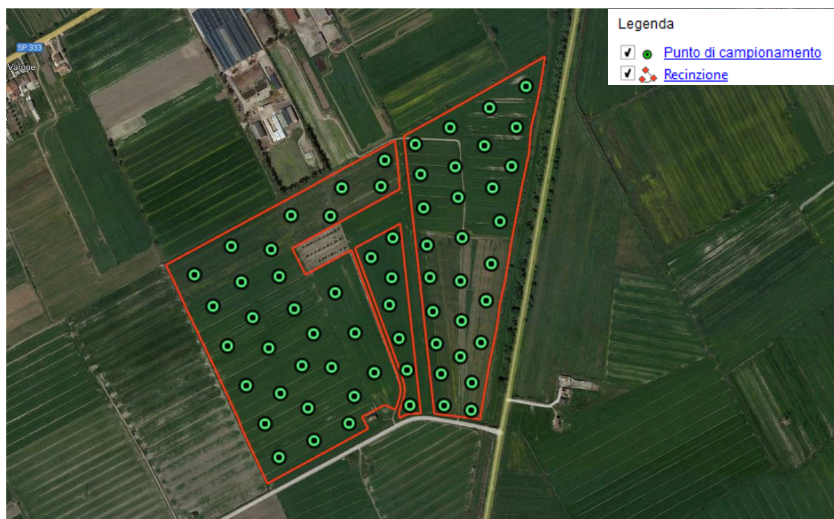
Figura 7 - Ubicazione n.64 punti di campionamento campo fotovoltaico
