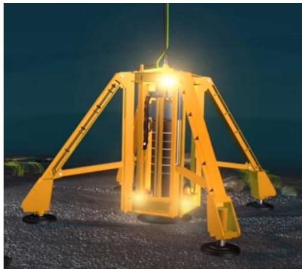
Figura 5-7 – Esempio di palo infisso nel fondale marino
