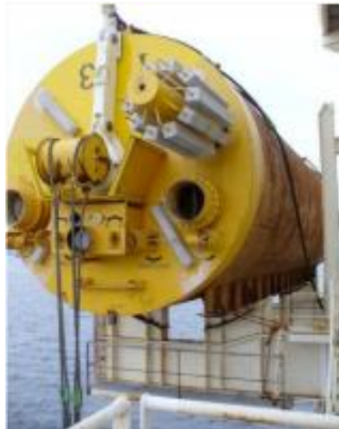
Figura 5-8 – Illustrazione di palo infisso per aspirazione
