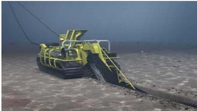
Figura 5-15 – Sistemi protezione dei cavi per interramento
