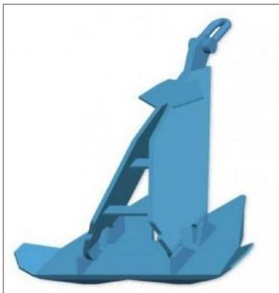
**Figura 2-5 – Esempio di ancora con trascinamento**
