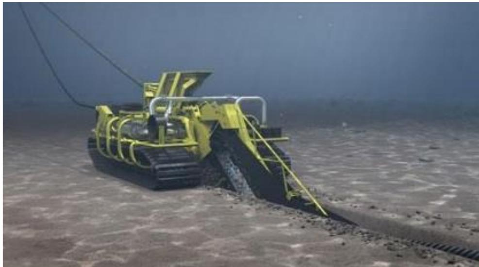
**Figura 2-15 – Sistemi protezione dei cavi per interramento**
