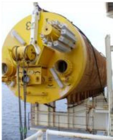
**Figura 2-8 – Illustrazione di palo infisso per aspirazione**
