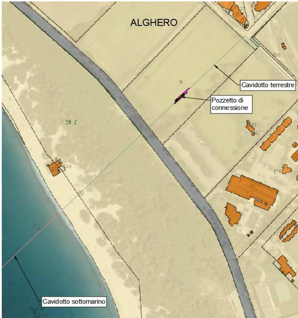
**Figura 2-17 – Pozzetto di giunzione allo sbarco (Transition Joint Bay – TJB)**
