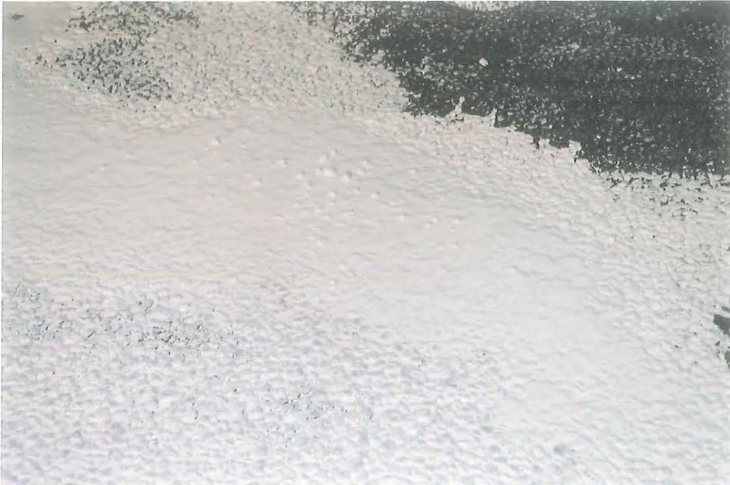
*Fig. 5.3 – Intasamento del tappeto poroso con boiaccia cementizia fotocatalitica*
