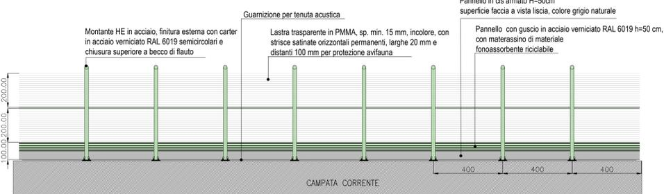
PROSPETTO BARRIERA "TIPO 1 B H4 TRASPARENTE", LATO RICETTORE
