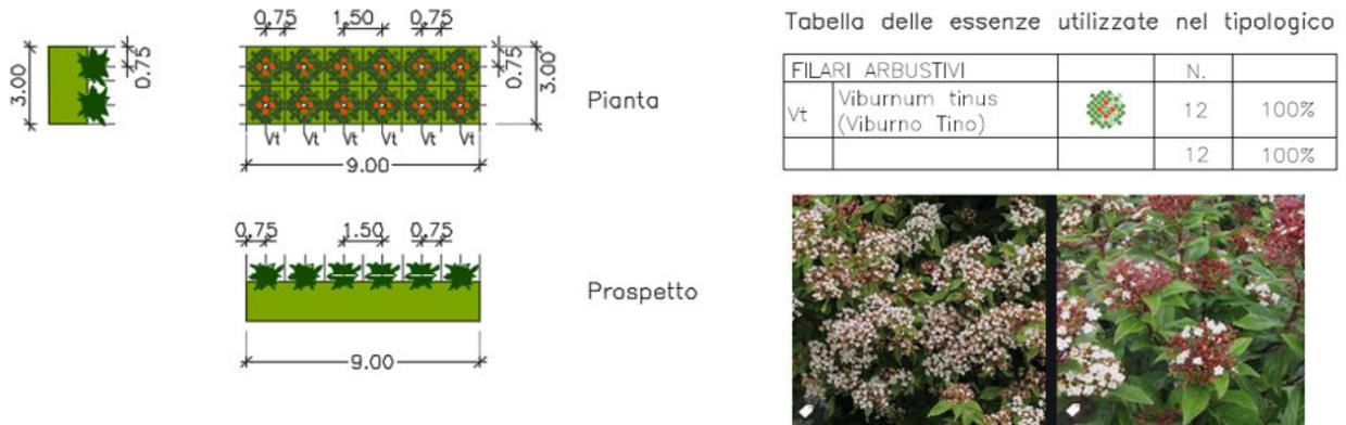
Figura 17 - Dettaglio del modulo AS1b – impianto arbustivo
