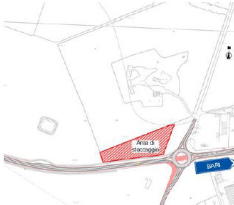
In tali aree è previsto lo stoccaggio provvisorio dei materiali di approvvigionamento e di tutti i materiali provenienti dalle lavorazioni (fresato da conglomerato bituminoso e rifiuto da costruzione e demolizione)
