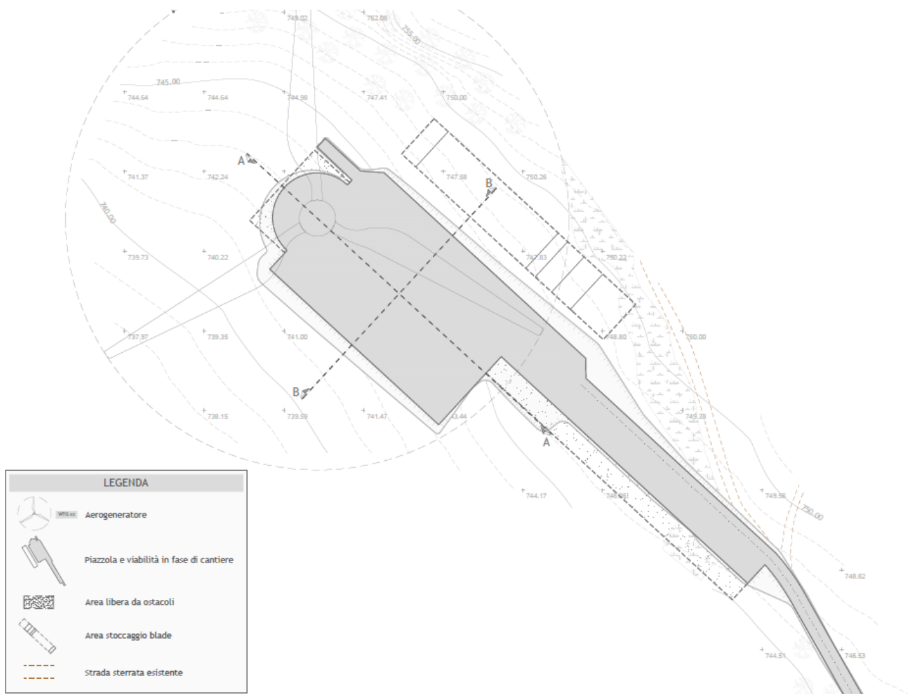
Figura 8 – Planimetria della WTG 04 in fase di cantiere
