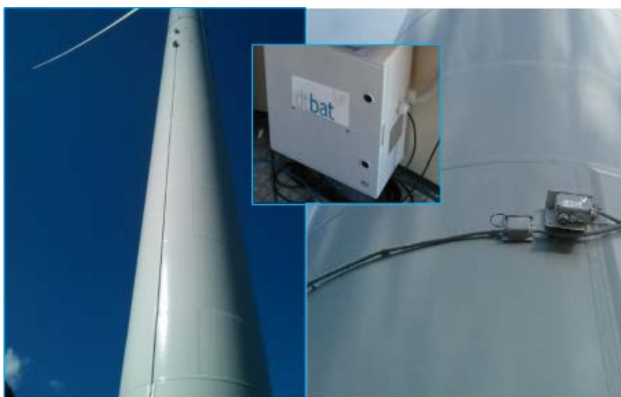
Figura 9 – Esempio di installazione di un sistema automatico su aerogeneratore per abbassare il rischio collisione
