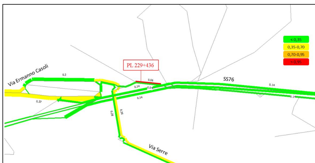
Figura 11 – Saturazione (flusso/capacità) degli archi viabilistici in prossimità del PL 229+436
