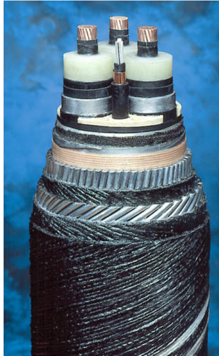
Figura 2-6 Sezione tipica del cavo marino XLPE tripolare in rame, con schermi in piombo, armatura in acciaio e fibra ottica
