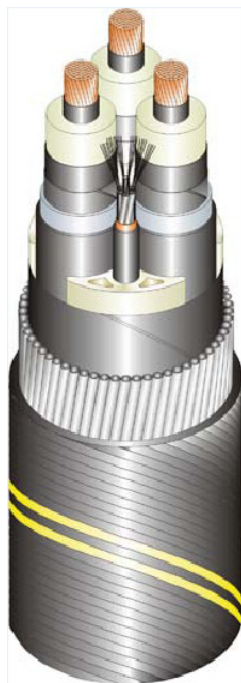
Figura 2-6 Sezione tipica del cavo marino XLPE tripolare in rame, con schermi in piombo, armatura in acciaio e fibra ottica
