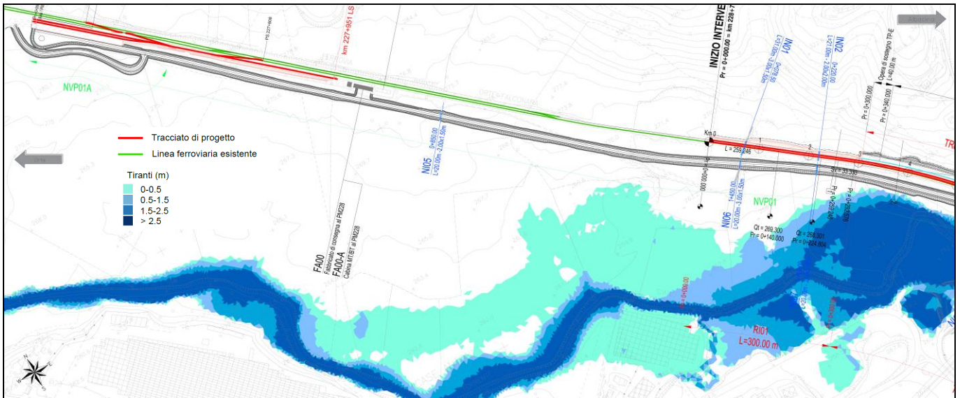
Fig. 17 – Modello numerico 2D del Torrente Giano: aree potenzialmente inondabili, post operam, per Tr = 200 anni, tav. 1 di 3.
