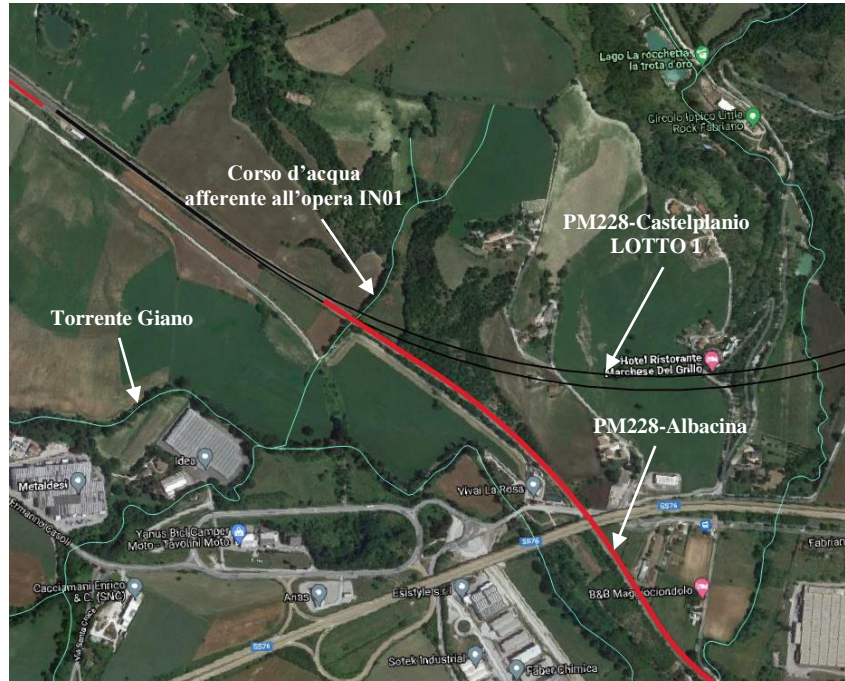
Figure 14 Interventi di raddoppio della tratta PM228-Castelplanio (Lotto 1, PM228-Bivio Nord Albacina) e della tratta PM228-Albacina.
