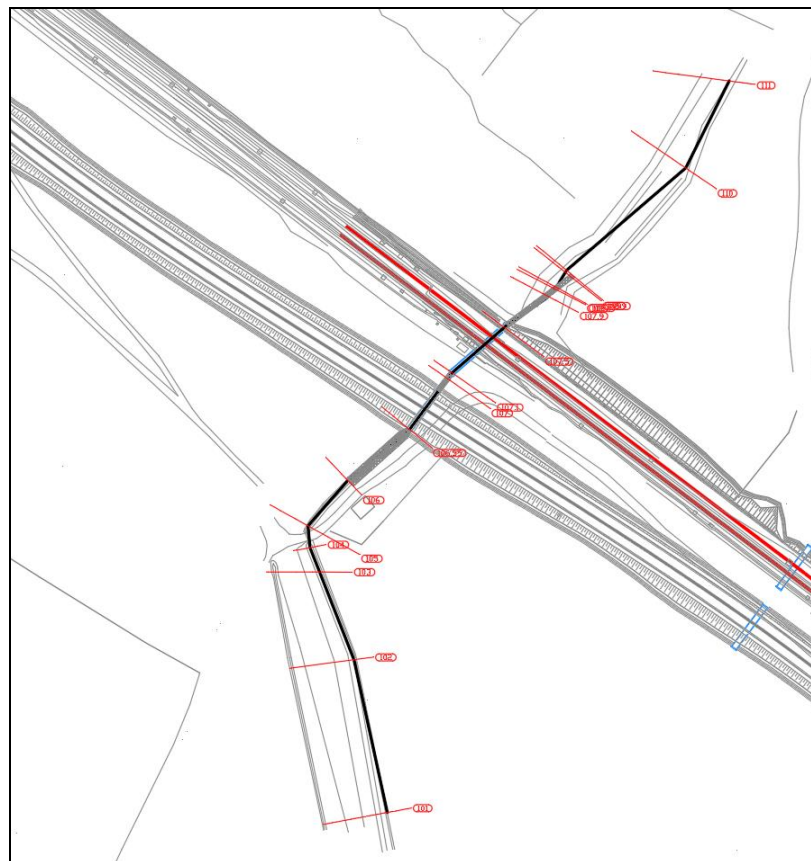
Figure 12 Schema planimetrico dell'asse IN01 e delle sezioni trasversali in condizioni Post Operam
