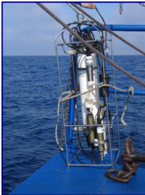
Figura 7 - La sonda multiparametrica SEA Bird durante le indagini nelle acque del Canale
