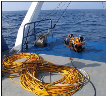
Figura 6 - Il ROV Hyball della Hydrovision a bordo della M/n Coopernaut Franca durante i rilievi nel Canale.
