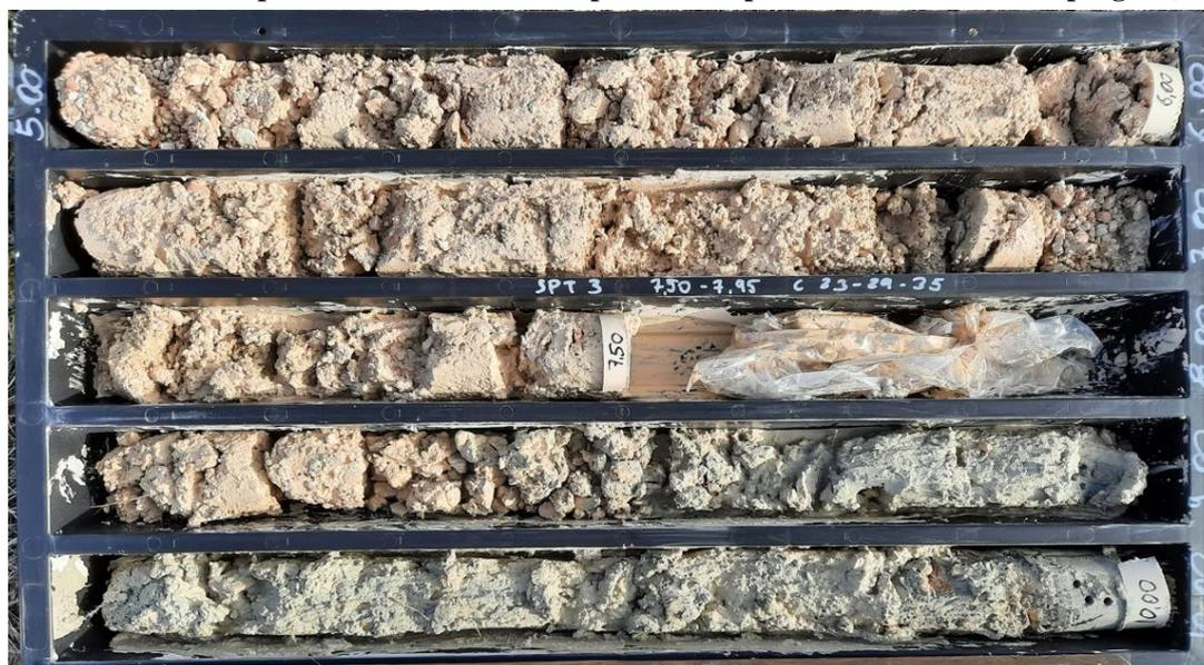
Figura 13. Depositi alluvionali antichi (Sintema di Matelica, MTIbn) rinvenuti nel sondaggio FCS71
