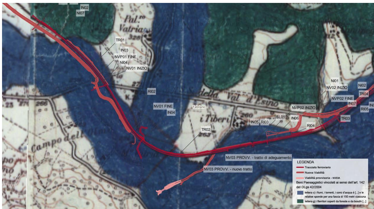
FIGURA 44 INQUADRAMENTO DELLE AREE DI PROGETTO IN RELAZIONE AL SISTEMA DEI VINCOLI DISPOSTI AI SENSI DELL'ART.142 DEL D.LGS 42/2004 IN PROSSIMITÀ DELLA FASCIA DI TUTELA DEL TORRENTE GIANO E DELL'AREA BOSCHIVA
