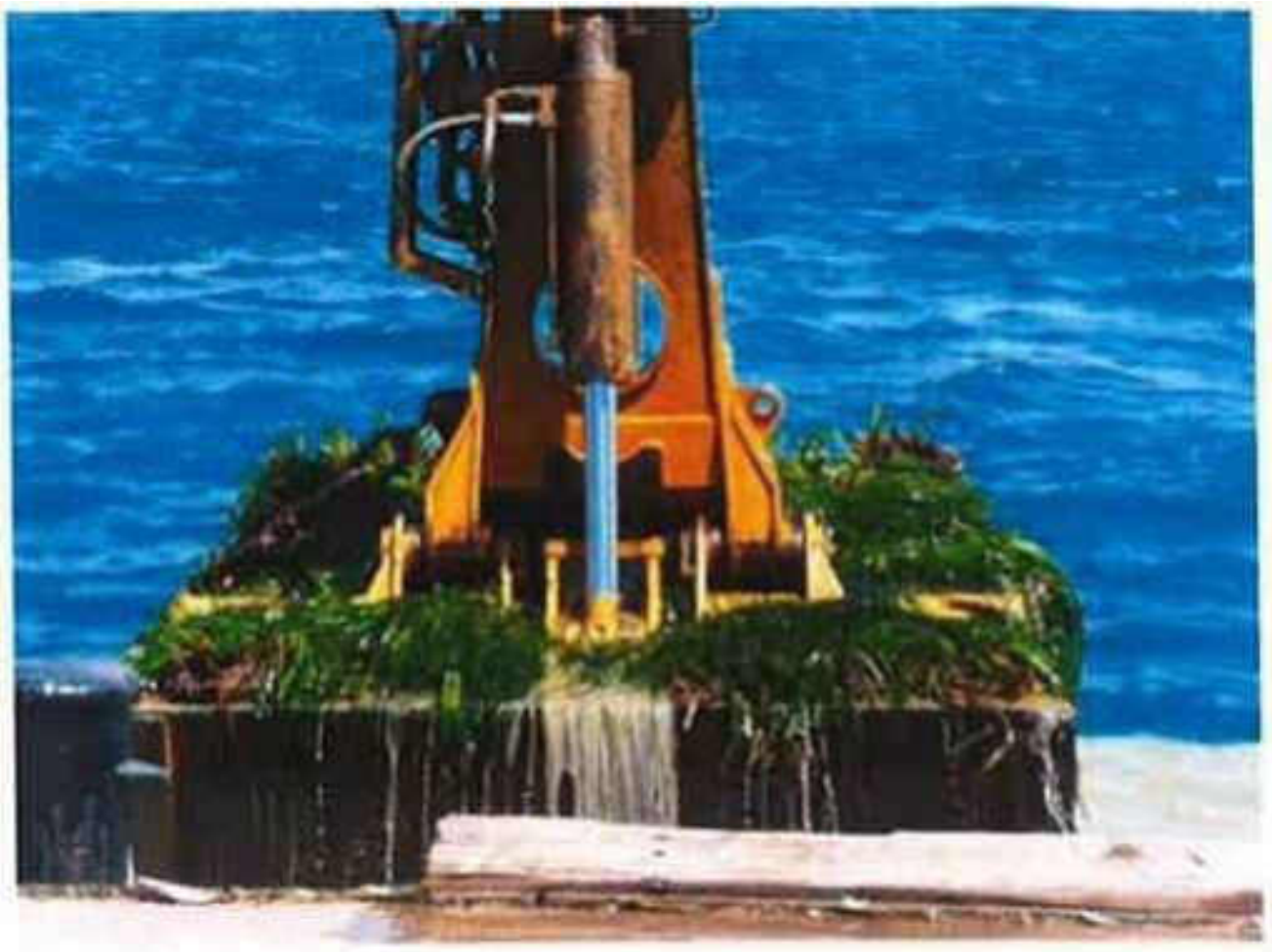
Figura 27 – Benna bivalve idraulica (da relazione Bedini 2014)
