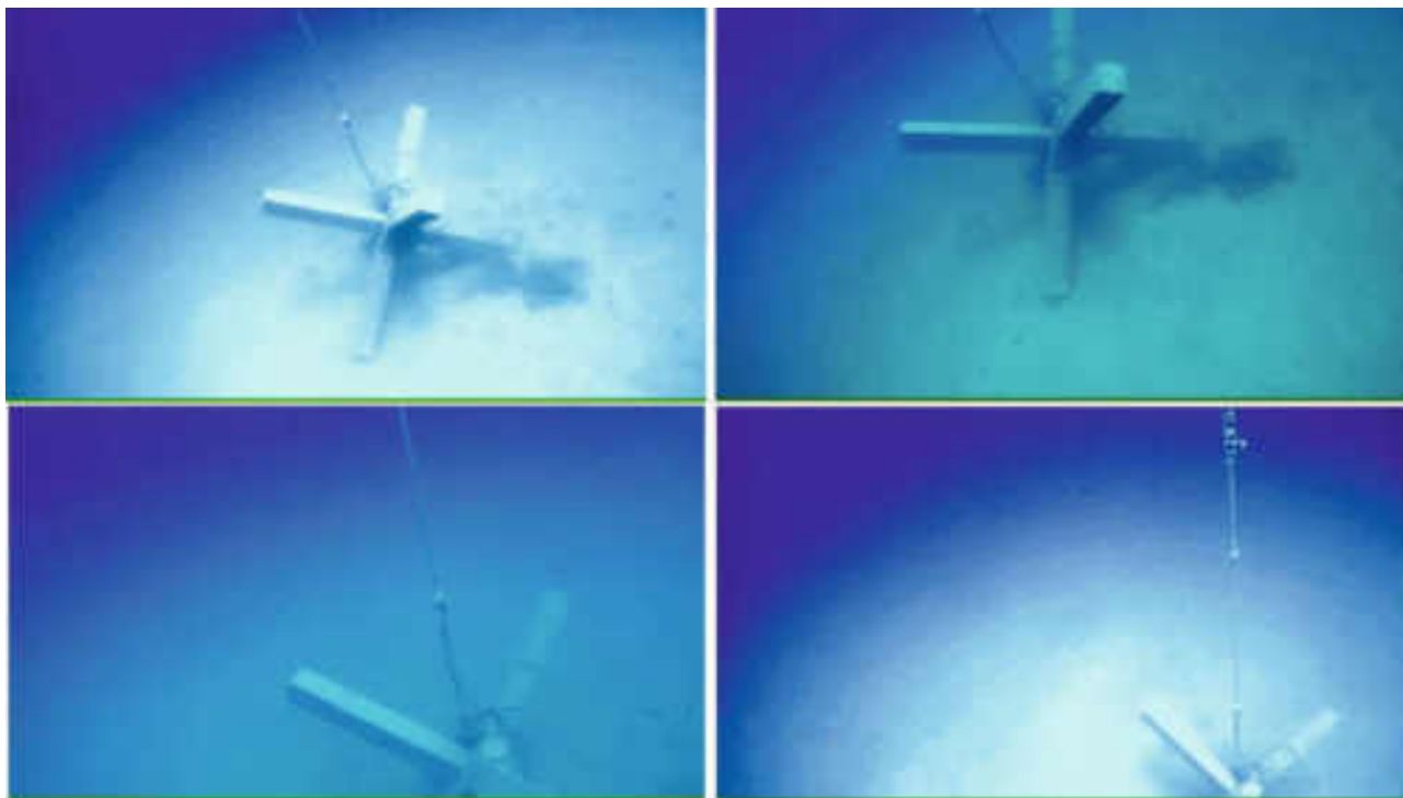
Figura 2 - Reti a strascico impigliate nei dissuasori
