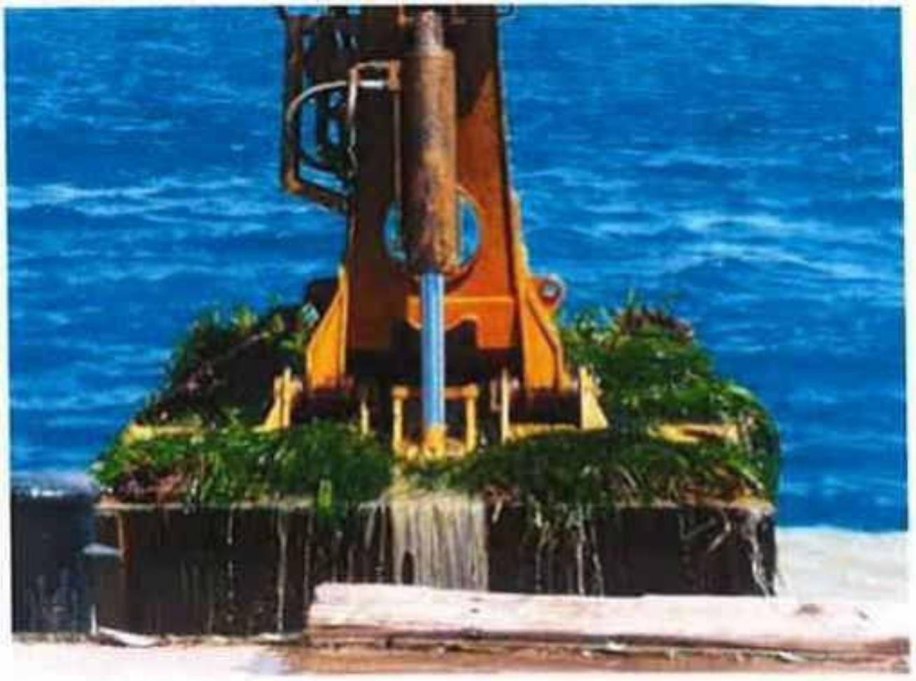
**Figura 27** – Benna bivalve idraulica (da relazione Bedini 2014)
