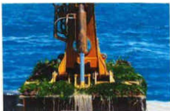
Figura 2 – Benna bivalve idraulica (da relazione Bedini 2014)
