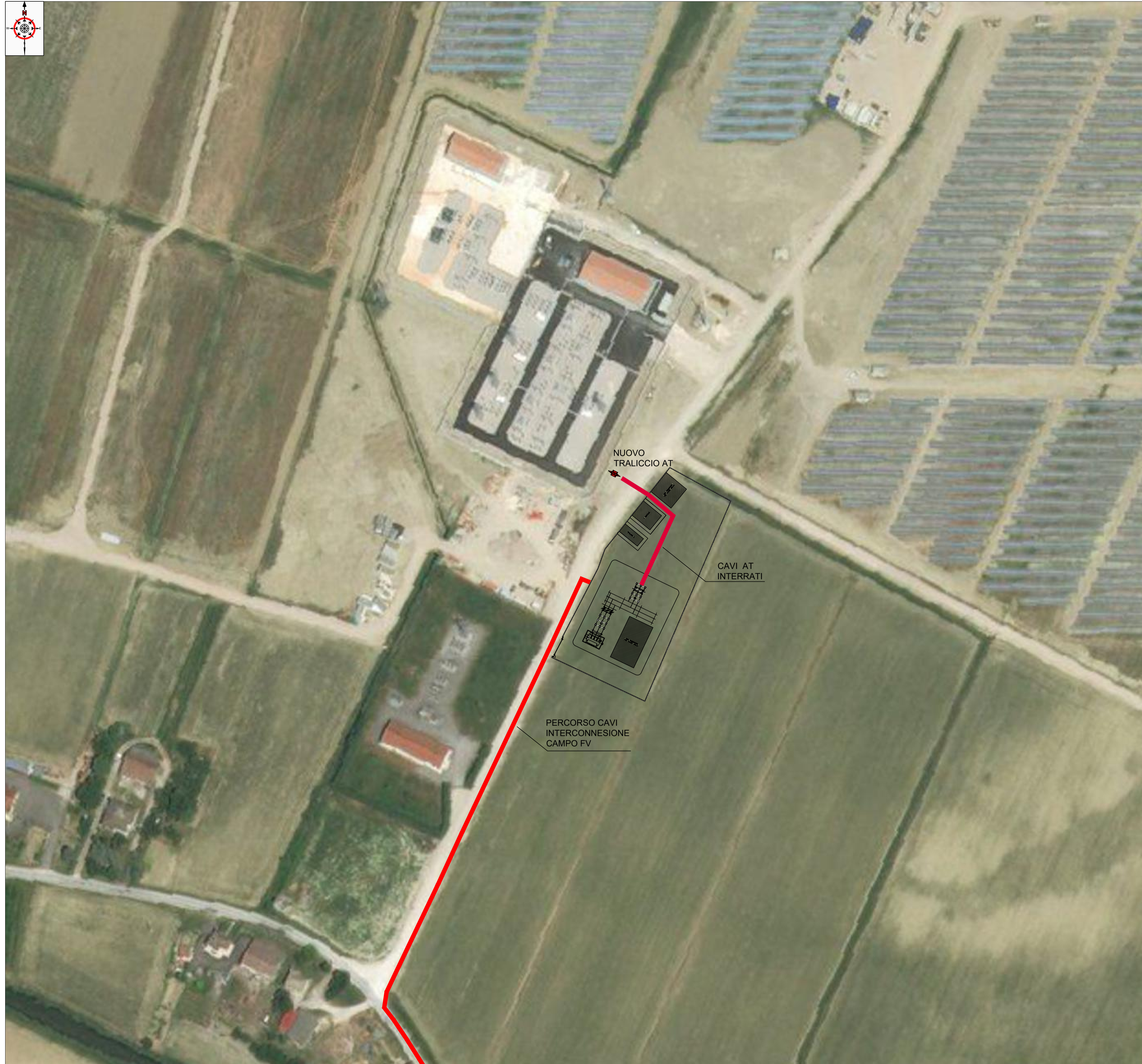
INQUADRAMENTO SOTTOSTAZIONE UTENTE - ORTOFOTO Scala 1:1000
