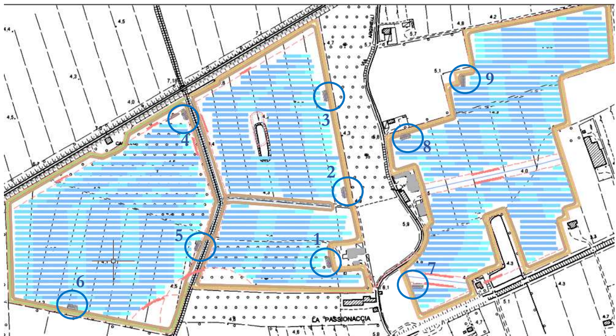
Figura 4 – Disposizione dei container
