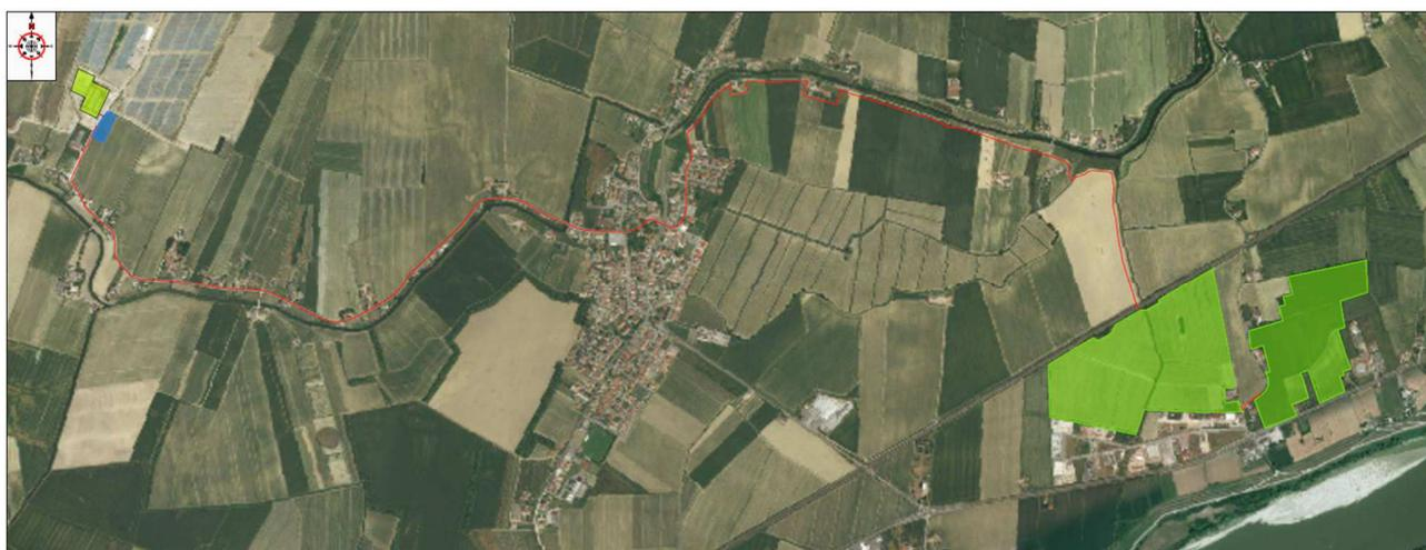
La linea elettrica in cavo alla tensione nominale di esercizio di 30 kV (MT) che collega l'impianto alla RTN attraverserà la tratta ferroviaria compresa tra le stazioni di Canaro e Polesella. Nell'immagine che segue si riporta il dettaglio del posizionamento dell'interferenza in cui si evidenzia il tratto di interferenza della nuova linea elettrica che sarà realizzata in teleguidata (in blu).
