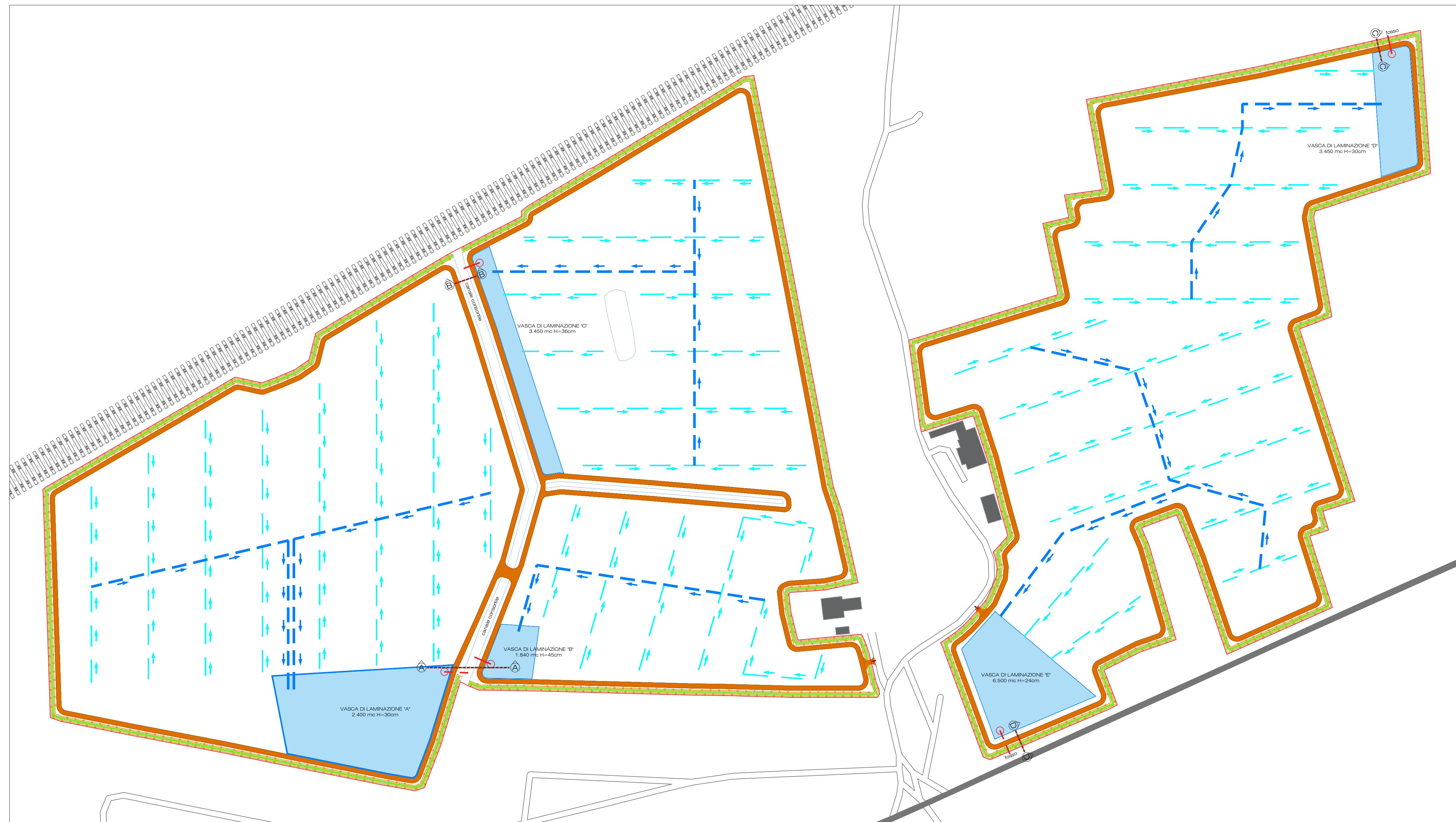
PLANIMETRIA SISTEMA DRENAGGIO E INVASI Scala 1:2000
