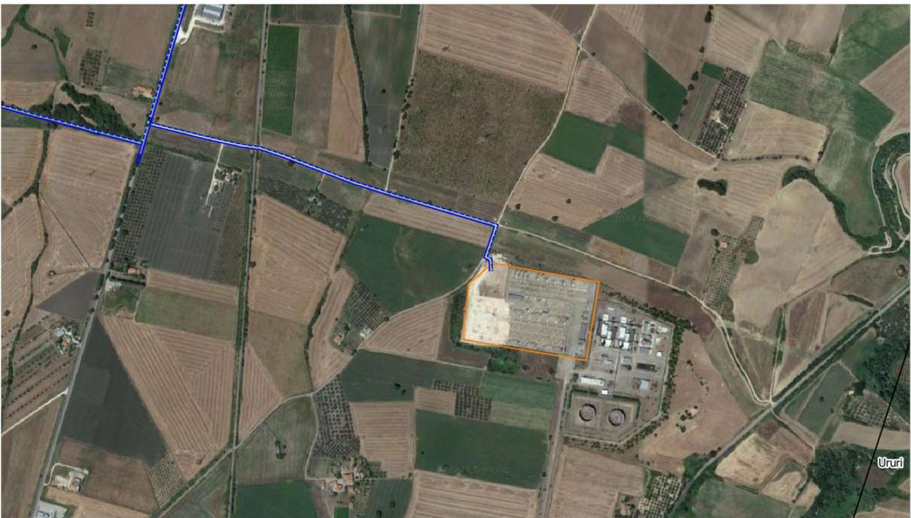
**Figura 9.3.2.1:** Collegamento delle turbine eoliche alla RTN in linea interrata a 36 kV
