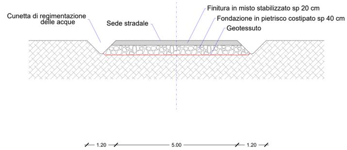
SEZIONE TIPO-SEZIONE IN RILEVATO\_SCALA 1:50
