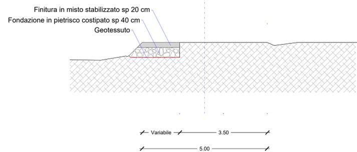
SEZIONE TIPO-ADEGUAMENTO VIABILITA' ESISTENTE\_SCALA 1:50
