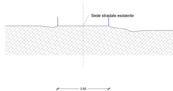
SEZIONE TIPO-ADEGUAMENTO VIABILITA' ESISTENTE\_SCALA 1:50
