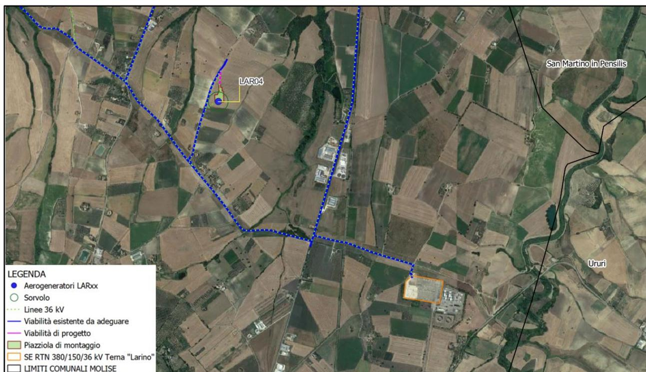
**Figura 4.3:** Arrivo delle linee elettriche a 36 kV in corrispondenza della nuova sezione a 36 kV della SE RTN 380/36 kV di Larino su ortofoto
